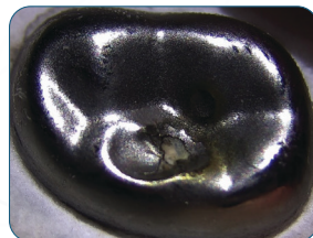
Couronne acier après 400 000 cycles d'essais d'usure à 80 newtons
