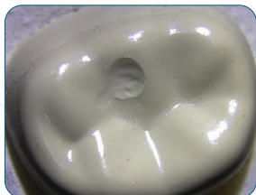
BioFlx après 800 000 cycles d'essais d'usure à 80 newtons
